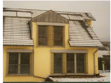
Halbgeschlossene Außenjalousien behindern solare Wärmege winne
