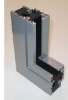
Gut thermisch getrennter Aluminiumrahmen U_F -Wert um 1,2 \text{ W/m}^2\text{K}
